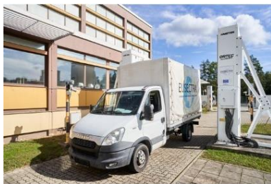
Figura 5-1. Imagen de un monitor de portal facilitada por el Centro Europeo de Formación en Seguridad Nuclear
